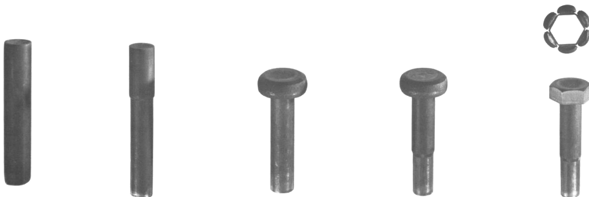
Corte do Blank | Redução do Corpo | Estampagem da cabeça | Redução da Rosca | Recorte do sextavado e chanfro da Ponta
